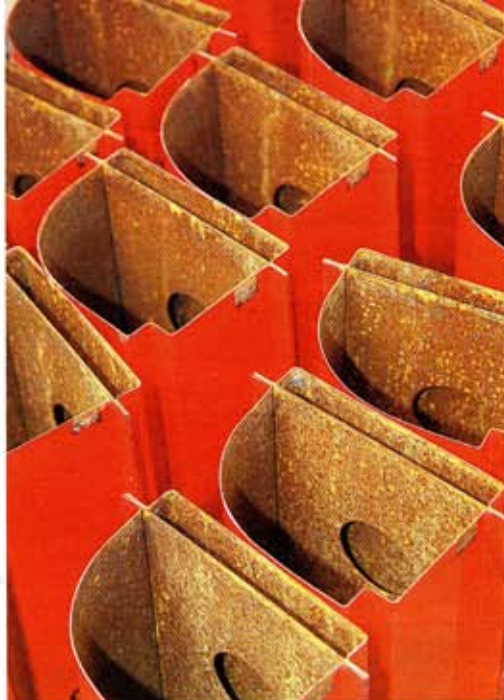
So sahen die Testschweller übrigens vor der Behandlung aus: gleichmäßig angerostet
