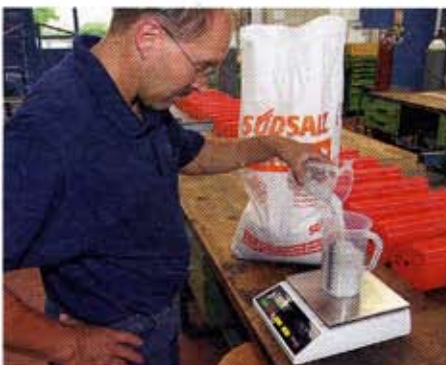
Ein Kilo Streusalz auf 20 Liter Wasser: Thomas Geis von der FAS rührt die Sprühlösung...
